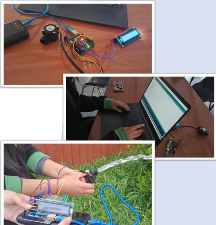
Fig. 2: Armado y prueba inicial del prototipo (versión 1.0).
